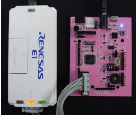
図 4-1 NS-RX231に電源アダプタとE1デバッガを接続した様子
